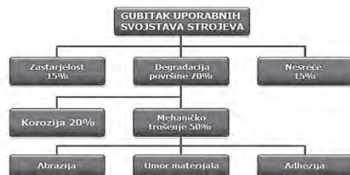
Slika 1. Uzroci gubitka uporabnih svojstava strojeva (Izvor: Noria Corp., 2013.)
