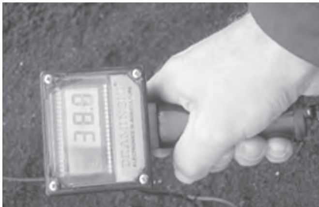
Slika 4. Mjerenje temperature kompostne hrpe
